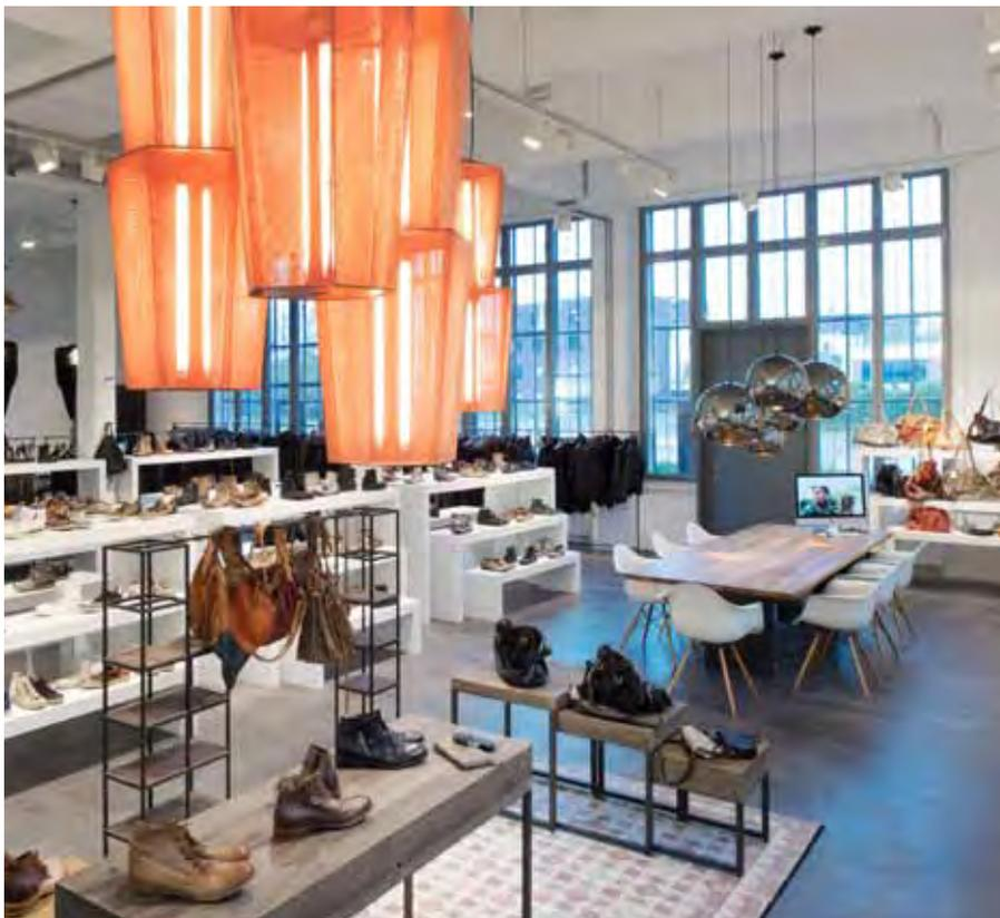
130 LED-Schienenstrahler mit austauschbaren 24W TECOH® LED-Modulen (warmweiß 3000K, 2700lm) wurden in 4,50 Meter Höhe unter den Hallendecken installiert. Die optisch sehr dezenten Strahler beleuchten die Produkt-Präsentationen hell, aber blendfrei.
