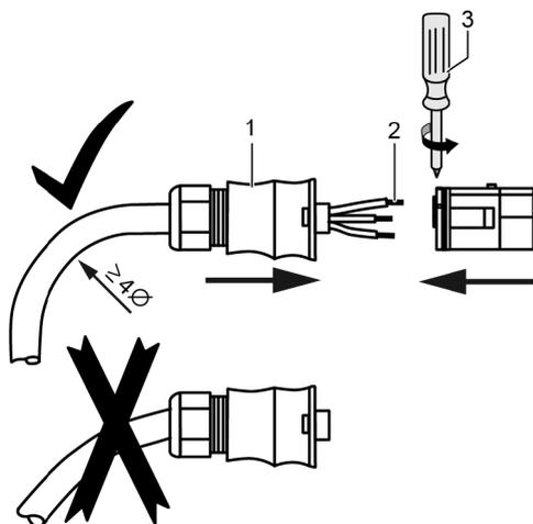
1. Kabel durch das Steckergehäuse führen. Steckergehäuse (1) auf das Kabel schieben.
