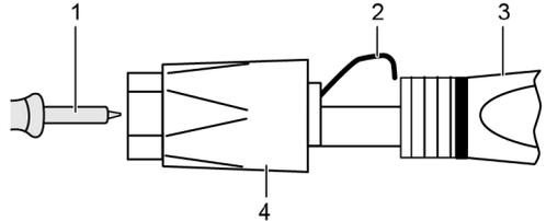
4. Feder (2) gegen das abisolierte Leitungsende drücken, bis sie hörbar einrastet. Sicherstellen, dass das Leitungsende fest sitzt.
