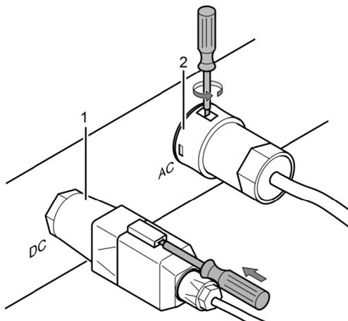
3. DC-Anschluss (1) vom Wechselrichter trennen: Schraubendreher in die Entriegelungsöffnung stecken, Schraubendreher eingesteckt lassen und Stecker abziehen.
