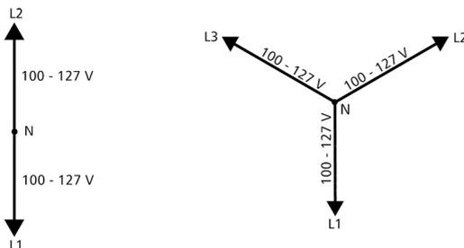
Die Spannung in 2- und 3-phasigen Netzen ist in jedem Außenleiter gleich hoch: 100 V bis 127 V.
