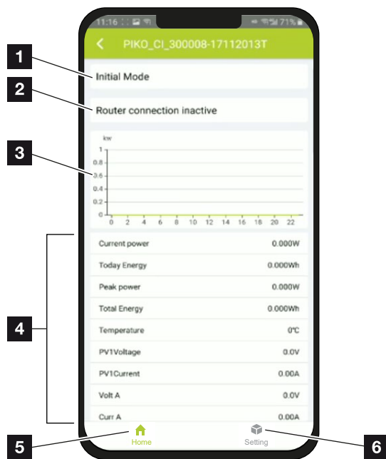
Abb. 33: App-Bereich Startseite > Betriebszustand
