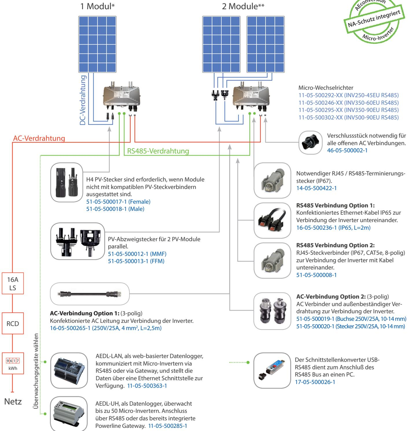
\* 1 Modul: 45V, 60V oder 90V max je nach Wechselrichter Version
