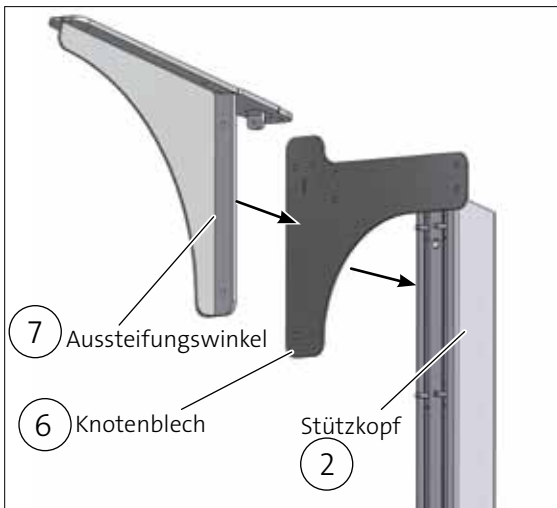
Abb. C2-6 Einbau Winkel 100° und Knotenblech
