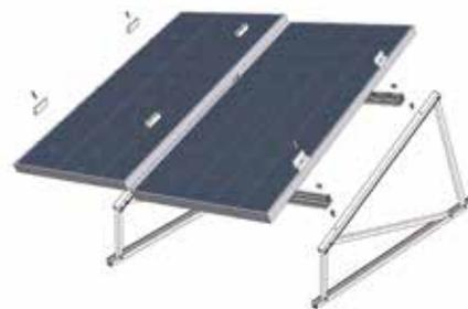
Die spezielle Gründachstütze bietet eine Montage mit Abstand zum Untergrund, z.B. für begrünte Dächer.
