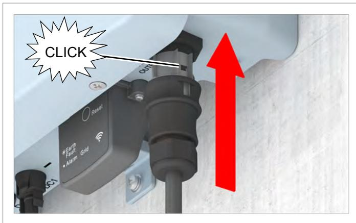
9. Den AC-Stecker in den AC-Anschluss des Wechselrichters stecken.
