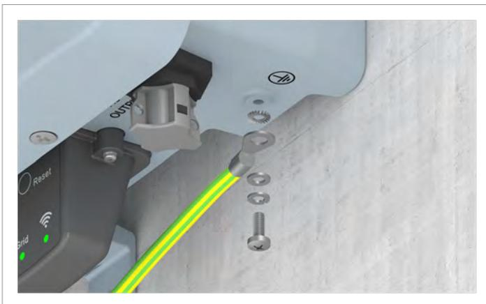
6. Das Erdungskabel am Wechselrichter anschrauben. Mutter, Federring, Unterlegscheibe und Zahnscheibe sind schon am Wechselrichter montiert.
